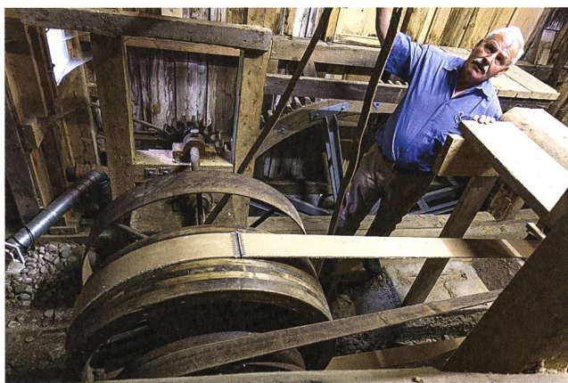
Fritz Rutz erklärt den Antrieb des Gatters der Hätschberg-Säge. Bild: Ernst Grob.
