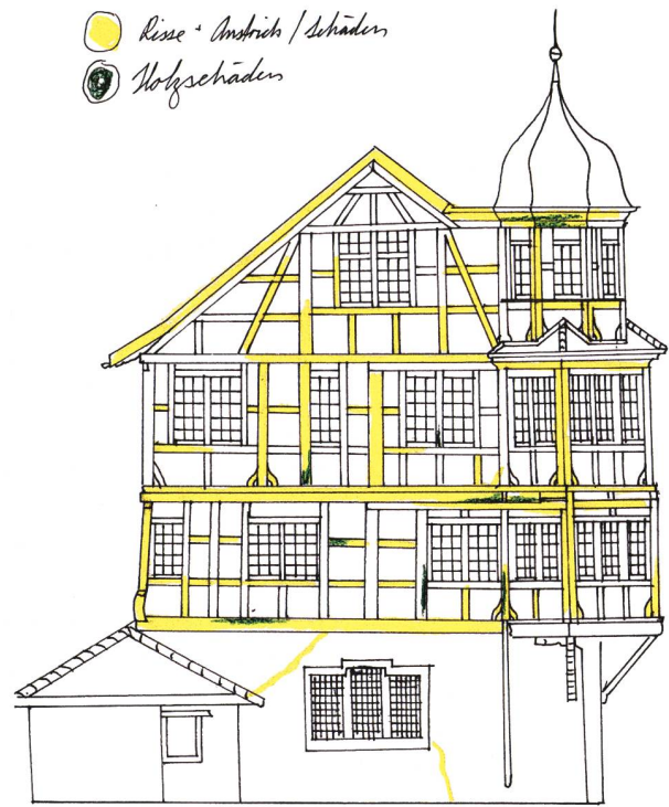
Eine Bestandesaufnahme durch Absolventen des Ausbildungslehrgangs Handwerk in der Denkmalpflege zeigt, dass nur wenige Holzteile dringend erneuert werden muss (gelb). Zudem sind im Verputz des Erdgeschosses verschiedene, jedoch nicht besorgniserregende Risse zu erkennen. Foto: Tommy Raths/Denkmalpflege Stadt St. Gallen.
