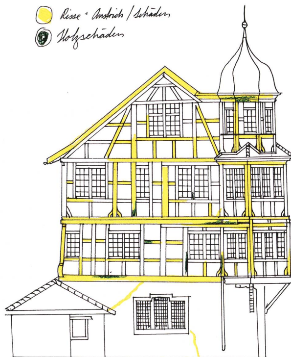
Eine Bestandesaufnahme durch Absolventen des Ausbildungslehrgangs Handwerk in der Denkmalpflege zeigt, dass nur wenige Holzteile Schäden aufweisen (grün) und auf dem Riegelwerk der Farbanstrich dringend erneuert werden muss (gelb). Zudem sind im Verputz des Erdgeschosses verschiedene, jedoch nicht besorgniserregende Risse zu erkennen. Foto: Tommy Rath/Denkmalpflege Stadt St. Gallen.
