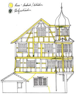
Eine Bestandesaufnahme durch Absolventen des Ausbildungslehrgangs Handwerk in der Denkmalpflege zeigt, dass nur wenige Holzteile Schäden aufweisen (grün) und auf dem Riegelwerk der Farbanstrich dringend erneuert werden muss (gelb). Zudem sind im Verputz des Erdgeschosses verschiedene, jedoch nicht besorgniserregende Risse zu erkennen. Foto: Tommy Raths/Denkmalpflege Stadt St. Gallen.
