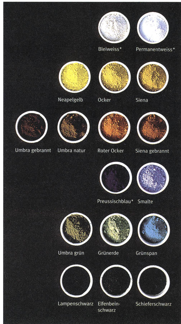
Verfügbare Pigmente bis 1800. Diese bescheidene Palette steht dem Baukünstler bis etwa 1800 zur Verfügung. Die meisten Pigmente sind Erdfarben, die an vielen Orten Europas vorkommen und nach dem Reinigen bereits verwendbar sind. Das helle Smalte-Blau ist zerstampftes, mit dem Metall Kobalt gefärbtes Glas. Das dunkle Blau z.B. Berliner- oder Pariserblau genannt, ist eine Eisenzyanverbindung. Grünspan entsteht aus Kupfer, das mit Essigsäure behandelt wurde. Die schwarzen Farben sind gebrannte Pflanzen, Knochen oder Russ.
