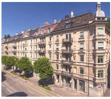
Dank einer grundsoliden Bauweise konnte auf eine Fassadenrenovation verzichtet werden. Aus Schallschutzgründen wurden aber die rund 30-jährigen Fenster durch neue, dem ursprünglichen Bestand angepasste Holzfenster ersetzt. Aufnahme Jürg Zürcher.
