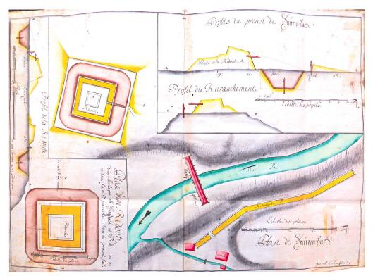
Beide Bilder: Sicherungsmassnahmen durch die fürstäbtische Regierung einerseits an der Brübacher Brücke, die über die Thur führt und das Stiftsgebiet mit dem Toggenburg verbindet, sowie ein Ausschnitt zur Befestigung des Kirchhofes von Zuzwil. Die getroffenen Massnahmen im Vorfeld des Kriegs von 1712 waren weitgehend wirkungslos. Pläne (Feder, farbig koloriert) von Matthias L. Kaufflin, um 1712. Quelle: StiftsASG, Bd. 824.
