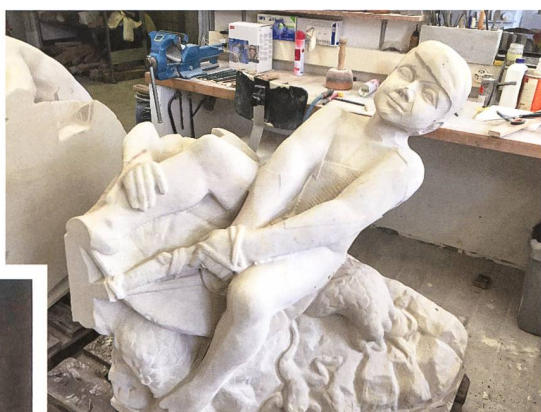
Bild oben: Produkt aus der Fräsmaschine. Die von der digitalen Erfassung herrührenden Reliefsuren sind noch gut zu erkennen und mussten von den Bildhauern überarbeitet werden.
