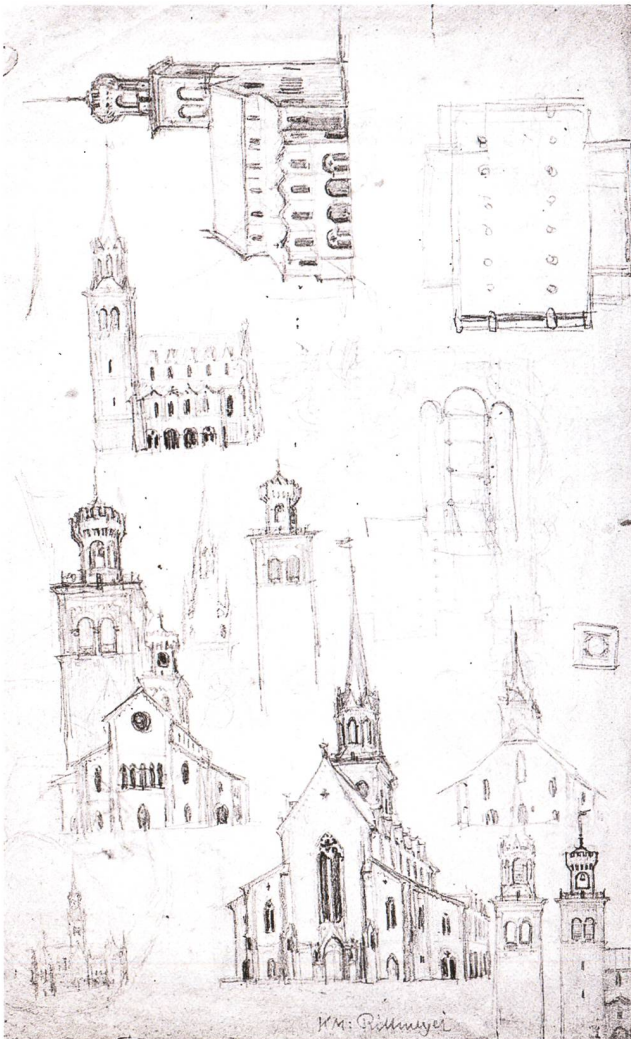
Bild oben: Varianten der Turmhelmprojekte zu J. G. Müllers Umbauplänen mit dem Versuch, das Mittelschiff zu «entgotisieren»
