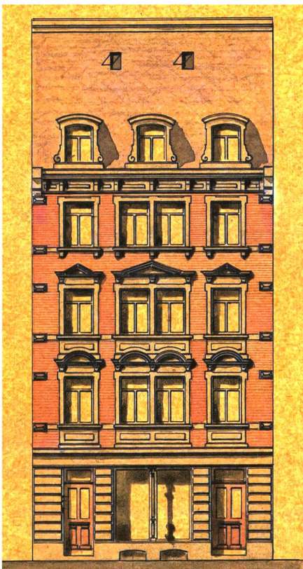
...1888: Klassizistische Fassadenelemente prägen den Entwurf der Architekten Scheier & Dürtscher. Beeindruckend sind die exakten Proportionen und die konsequente Materialisierung.
