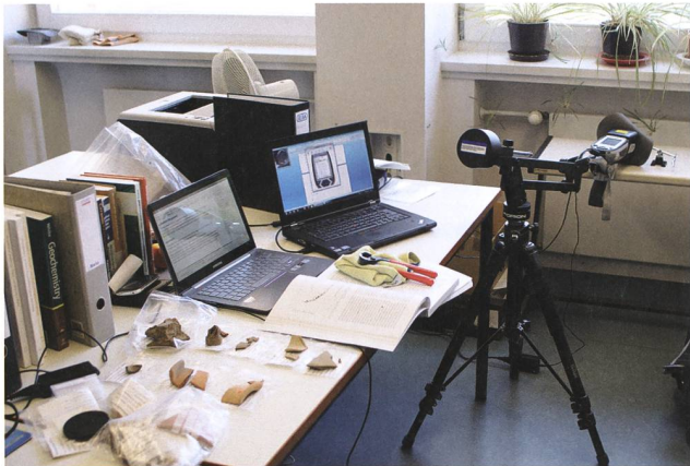
Frankfurt am Main, Institut für Archäologische Wissenschaften (IAW). Die mit der Zange vorbereiteten Keramikproben von Kempraten werden mit dem portablen RFA-Gerät analysiert und die Resultate direkt auf den Computer übertragen. Foto KASG.
