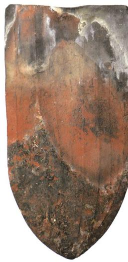
Ab dem 11. Jahrhundert wurden die Flachziegel mit Haken entwickelt. Anfänglich waren sie gross und schwer. Der untere Schnitt kann verschiedene Ausprägungen haben.
