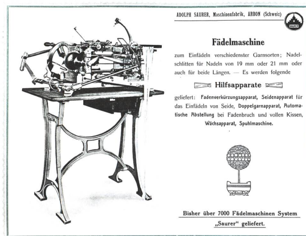
Abb. (6): Die Fädelmaschine der Maschinenfabrik Adolph Saurer bedeutete eine wesentliche Arbeitserleichterung. Quelle: TexBib T 7.1 .
