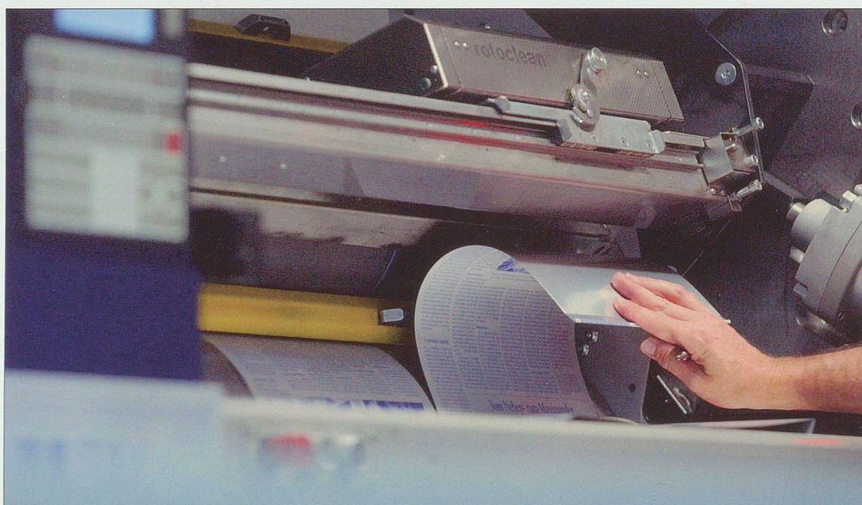
Die Druckplatte wird in die Rotationsmaschine eingespannt.
