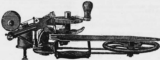
Cette machine fait un point double et élastique. Ses qualités sont vitesse dans l'opération, simplicité dans le mécanisme, élasticité, solidité et durée du point. Elle est légère, de petit volume, très maniable et exécute le travail sur tous genres de tapis.
