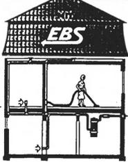
Staubsaugergeräte und daraus zusammengestellte Zentralstaubsauganlagen.
