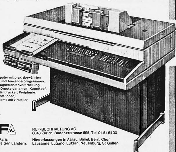
RUF-Praelor-Computer mit praxisbewährten Betriebssystemen und Anwenderprogrammen. 2 bis 64 K-Byte, Magnetknotenverarbeitung bis 1024 St./Seite. Druckervarianten: Kugelkopf, Nadeldrucker, Zeilendrucker. Peripherie: 1/4"-Magnetbandstationen, Magnetplattensysteme mit virtueller Adressierung.
