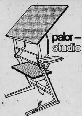
Beim palor-Studio ist das Zeichnungsbrett ohne Gegengewicht verstellbar. Der Gewichtsausgleich erfolgt durch zwei Federn. Der Raum zwischen den Füßen des Tisches bleibt dadurch zur Anbringung eines Abstelltabliers frei.
