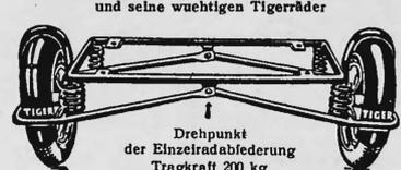
Drehpunkt der Einzelradabfederung
