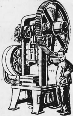
Spezialvorrichtungen für verstellbaren Hub, Revolver-scheibe, automat. Vorschub etc
