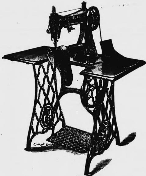
Les machines de la classe 19 ont un bras cylindrique de 41 cm de longueur, laissant entre l'aiguille et la base du bras un espace de 26 cm.
