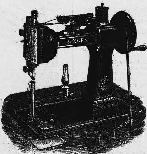
Cette machine occupe la première place dans la fabrication du gant. Elle est simple et fournit un travail régulier avec minimum d'usure.
