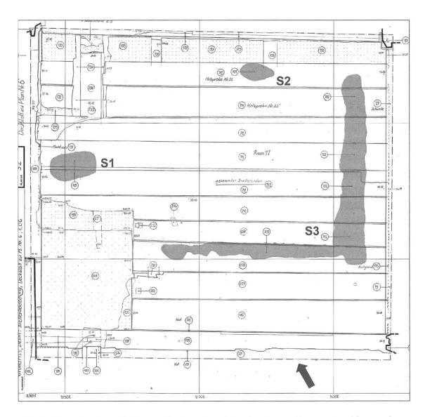
Abb. 7: Haus St.-Oswalds-Gasse 10, Zug. Grundriss des Raums 11 im ersten Obergeschoss. Die originalen Bodenbretter weisen Schabspuren (S1, S2, S3) auf, die vom Aufsetzen von Füssen respektive Schuhen stammen. Quelle: Amt für Denkmalpflege und Archäologie Zug, Direktion des Innern (Jonathan Frey).
