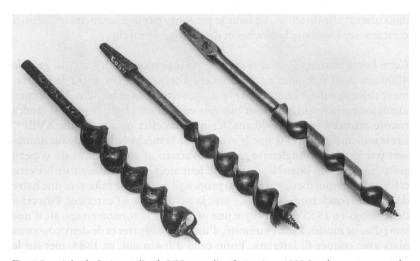
Fig. 6: La mèche de droite est dite de L'Hommedieu, brévetée en 1809. Les deux autres sont des mèches Jennings à lame d'acier tordue en spirale.
