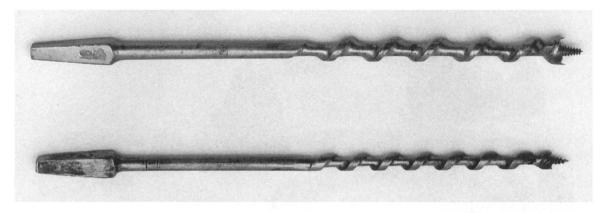
Fig. 7: Deux mèches Irwin, dont le brevet remonte à 1884, à spirale lâche autour d'un pivot central.
