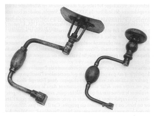
Fig. 8: Le vilebrequin de droite est le modèle produit en masse dés le début du 19ème siècle. Celui de gauche est intéressant par la présence d'une «conscience» en lieu et place du pommeau.
