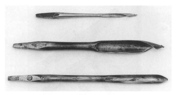
Fig. 3: La mèche du bas est en cuillère simple, et les deux du haut sont en colimaçon.
