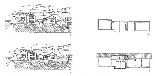
Fig. 2: Insertion d'un logement et d'un couvert à Branson (Roland Vassaux). 1. Etat initial, 2. Etat rénové, 3. Rez-de-chaussée couvert, 4. Sous-sol appartement.
