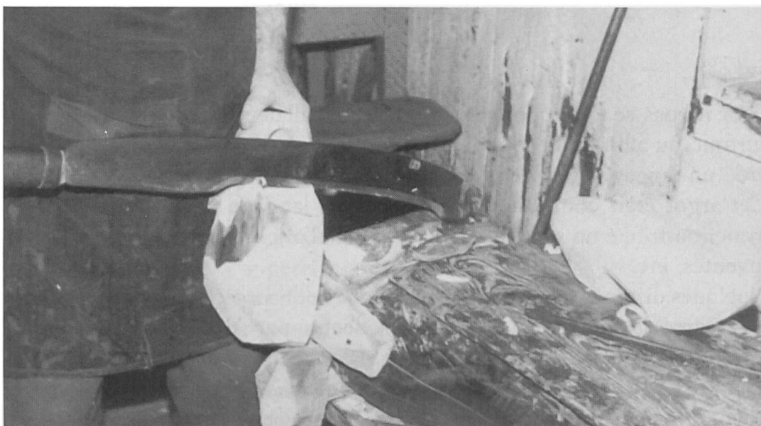
Dégrossissage du sabot avec le couteau de banc
