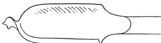
fig. 5. Foret avec vrille, largeur du tranchant 3 cm.
