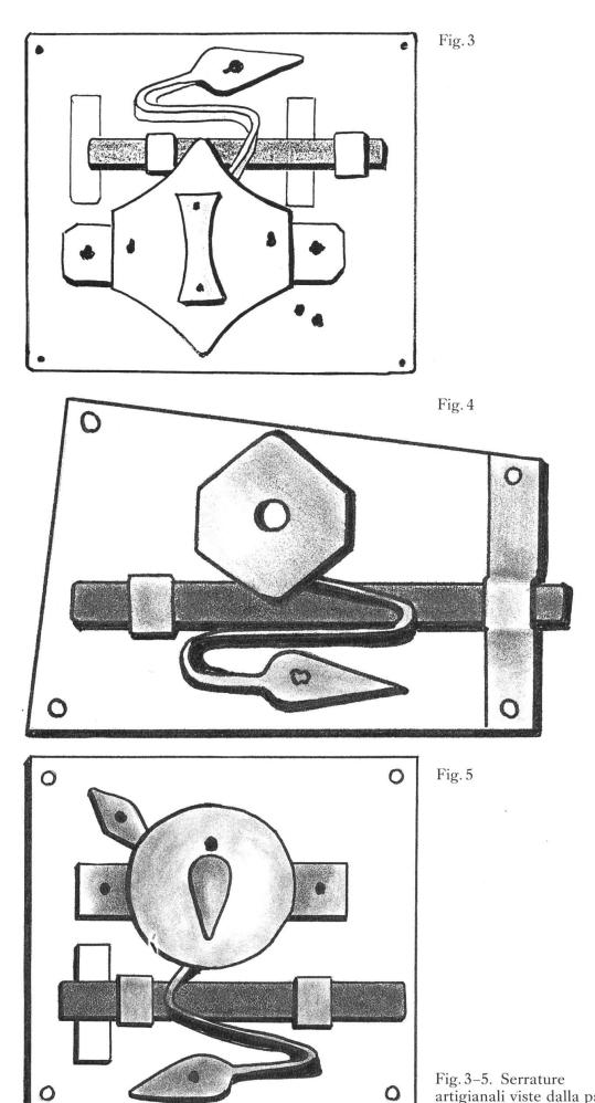
Fig. 3–5. Serrature artigianali viste dalla parte del meccanismo.
