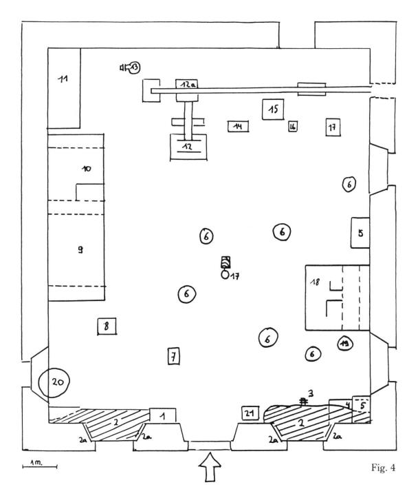
lan» utilisant l'eau du torrent. Ultérieurement ce système a été remplacé par une soufflerie hydraulique. A cette fin, une seconde roue à eau a été installée sur le torrent, en amont de celle reliée au martinet. Finalement un soufflet électrique a été posé au centre de l'atelier et relié à tous les postes de travail.
