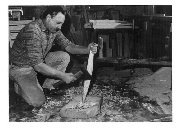
Fig. 2. Lavoro di sbozzo di una traversa.
