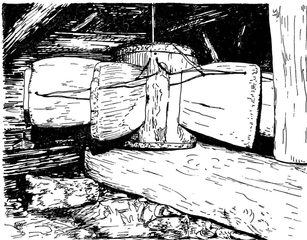
Fig. 9. Chandolin, août 1975. – La roue à eau du deuxième moulin, aux quinze pales retenues par un fil de fer
