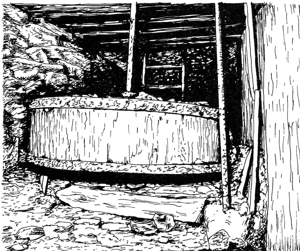
Fig. 35. Itravers, septembre 1977. – La roue du moulin, bordée de bois et cerclée de fer
