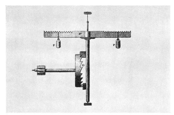
Fig. 4 Echappement à foliot (Waagbalken)
