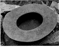
Fig. 13/14. Un contromodello in ghisa che, riscaldato, serviva a «stirare» e a dare la forma definitiva al cappello.
