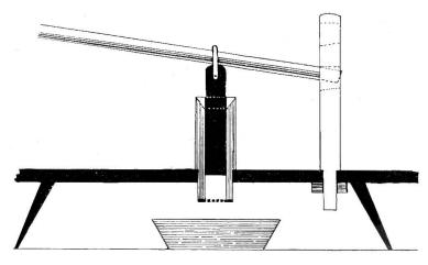
Fig. 2. Schéma du pilon à pommes de terre.
