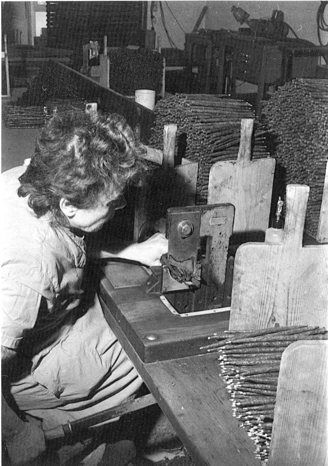
Abb. 9. Unter der Guillotine erhalten die Brissagos die vorgeschriebene Länge von 21 cm.
