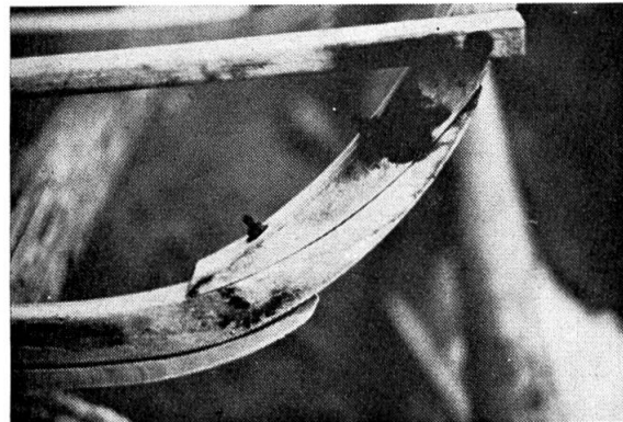
Abb. 6. Verbindung Horn-Kufe-Sohle bei Engeler Schlitten
