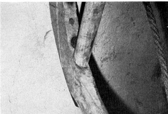
Abb. 7. Verbindung Horn-Spange bei Elmer Schlitten
