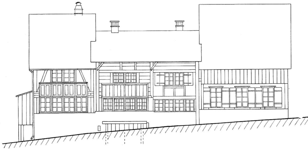
Abb. 9 – Wald ZH, 1791. «Flarzhäuser». Zweiraumtiefe Ständerbauten, an welche nach rückwärts kleine Wirtschaftsteile angehängt sind. Stuben gegen die Strasse gerichtet mit gekuppelten Fensterfronten. Das mittlere Haus besitzt noch das alte flache «Tätschdach», während die beiden andern nachträglich aufgestockt wurden.
