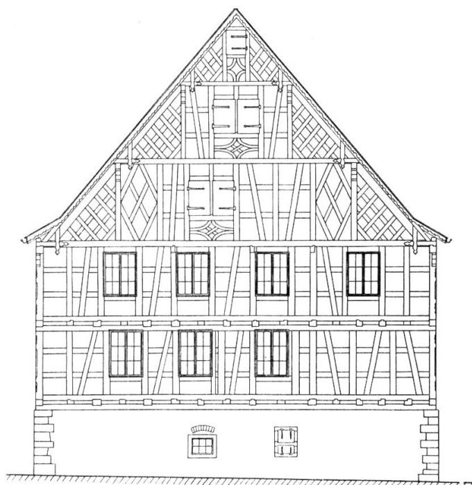
Abb. 6 – Berlingen TG. Typische ostschweizerische Fachwerkfassade mit stockwerkweise abgebundenen Ständern und stehendem Stuhl. Massives Kellergeschoss.
