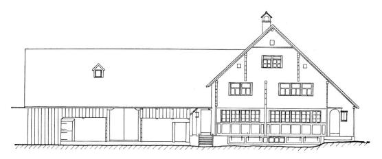
Abb. 1 – Teufen AR, 1726. Kreuzfirst mit langgestrecktem Wirtschaftsteil und zwei Ställen beidseits des Futtertenns. Wohnteil bestehend aus unverschalter Blockkonstruktion. Webkeller.
