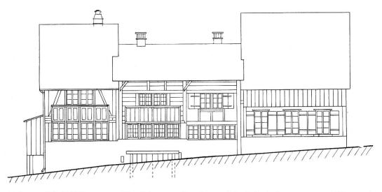
Abb. 9 – Wald ZH, 1791. «Flarzhäuser». Zweiraumtiefe Ständerbauten, an welche nach rückwärts kleine Wirtschaftsteile angehängt sind. Stuben gegen die Strasse gerichtet mit gekuppelten Fensterfronten. Das mittlere Haus besitzt noch das alte flache «Tätschdach», während die beiden andern nachträglich aufgestockt wurden.
