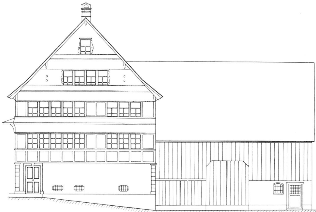
Abb. 2 – Oberbuchten SG , 1708. Kreuzfirst mit typischem hohem Wohnteil. Zugläden hinter Verschalungen versteckt, umlaufendes Klebdach mit verschalter Untersicht. Hohes massives Kellergeschoss.
