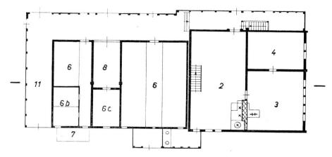
Abb. 5 – Schlatt AI. Sekundärer Vielzweckbau mit konstruktiv getrennten Blockgehäusen für Wohn- und Wirtschaftsteil. Die umlaufende Ständerwand täuscht äusserliche Einheit vor, verstärkt durch den durchgehenden First. Wohnteil mit grosser Küche in der ganzen Hausbreite.
