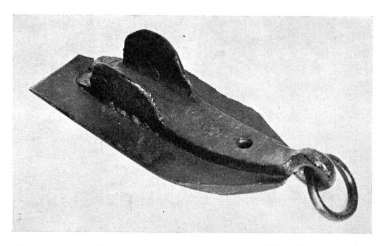
Abb. 5. Radschuh, Eisen, 39,5 cm lang, Backenbreite 15,5 cm. Fallera (Kt. Graubünden).
