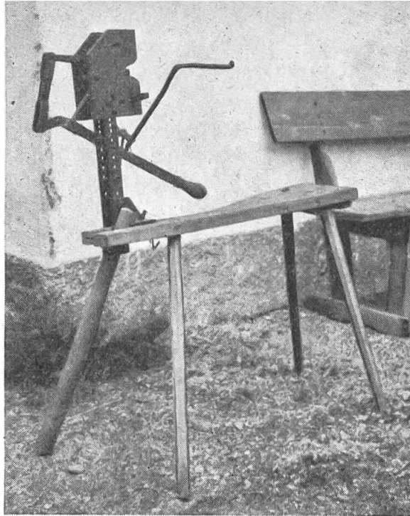
Abb. 4: Klosters-Aeuja (Prätigau) Dengelmaschine
