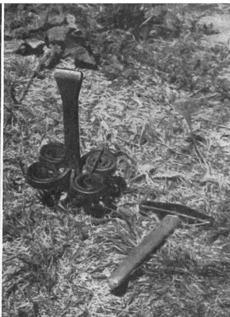
Abb. 3: Monte Refontana, Gemeinde Braggio (Val Calanca) Dengeleisen mit schneckenförmig ge- bogenen Bändern, das zum Dangeln auf der Erde dient. Daneben liegt der kurzstielige Hammer mit der breiten Schlagfläche.
