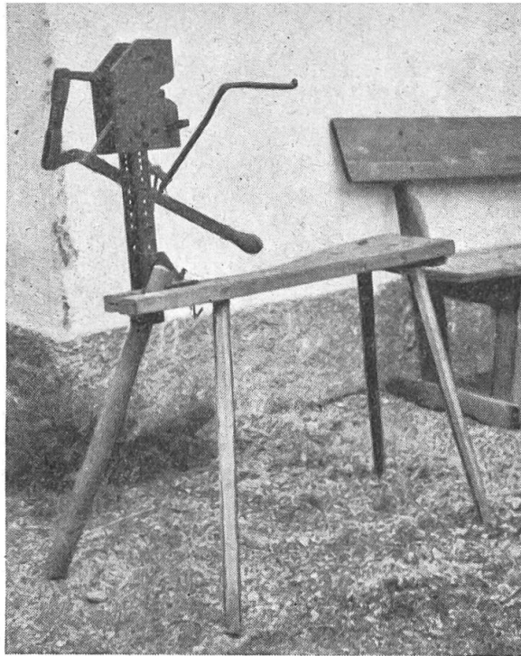
Abb. 4: Klosters-Aeuja (Prätigau) Dengelmachine
