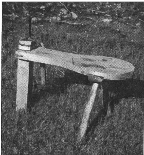
Abb. 2: Cavorgia, Gemeinde Sedrun (Vorderrheintal) Dengelstuhl, dreibeinig, wobei die vordere, stärkere Stütze gleichzeitig als Dangelholz dient. Damit es nicht gesprengt wird, ist es mit Draht umwunden. Am Dengeleisen hängt der Dengelhammer.
