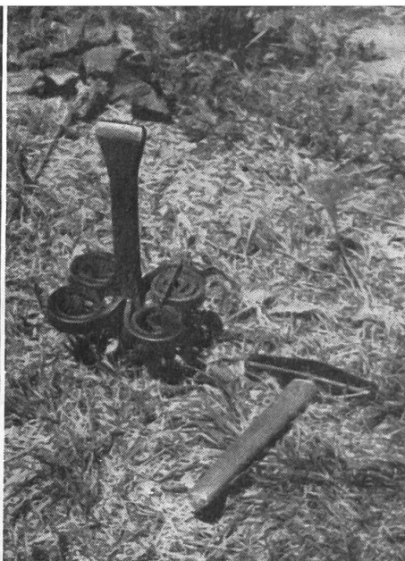
Abb. 3: Monte Refontana, Gemeinde Braggio (Val Calanca) Dengeleisen mit schneckenförmig ge- bogenen Bändern, das zum Dengeln auf der Erde dient. Daneben liegt der kurzstiellige Hammer mit der breiten Schlagfläche.
