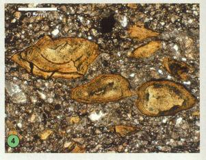
Fig. 4: Kompaktierte gelblich-grüne Eisenooide (Chamosit-Ooide) in sandigem intraklastischem Packstone. Die Eisenooide zeigen Risse und Kollapsstrukturen. NPL. Seitenbohrkern 4414 m. Übergang Dogger-Malm.
