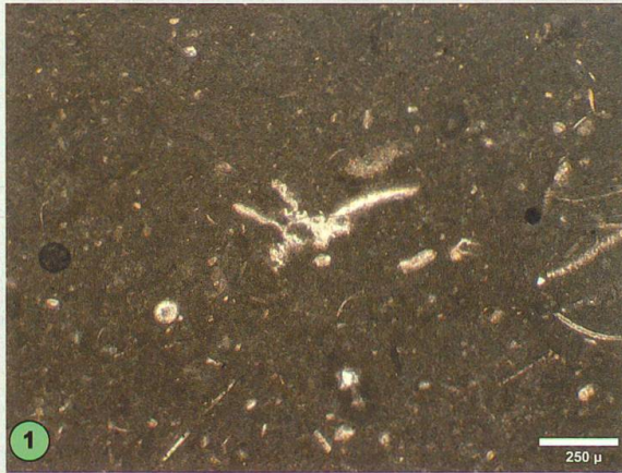
Fig. 1: Pelmikrit mit Tuberoïden, Intraklasten, Resten von Bositra und Saccocoma (Echinodermata, freischwebende Seelilie). Die Komponenten «schwimmen», schlecht sortiert, in mikritischer Grundmasse. Mikritischer Tuberoïdkalk XPL. Seitenbohrkern 4283 m Malm (Kimmeridge).
