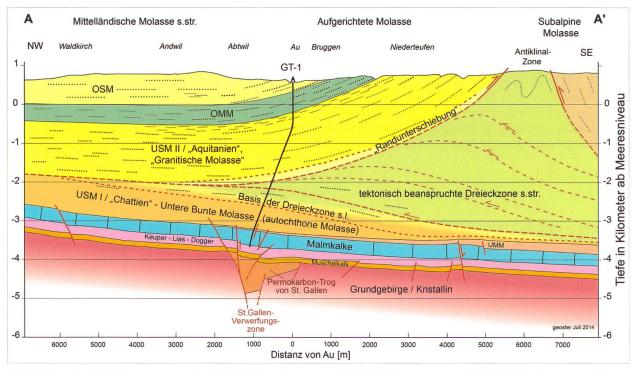
Abbildung 2: Geologisches NW – SE-Profil durch den Bohrstandort Au im Sittertobel mit dem ausgeführten, abgelenkten Bohrpfad von GT-1; Profilspur siehe Abbildung 1. Definitive Version 2014 nach Kalibrierung der 3D-Seismik mit den Bohrungsdaten gemäss HEUBERGER & KUHN 2014.
