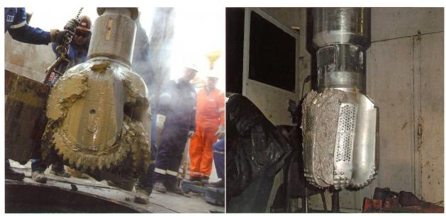
Abbildung 6: Links: Konventioneller 23"-Rollenmeissel, wie er in der Sektion 1 zum Einsatz kam, stark mit tonreichem Bohrgut verklebt. Rechts: Moderner 18"-PDC-Meissel teilweise noch mit Bohrgut aus der jüngeren USM (Oberaquitane Mergelzone in Sektion 2).
