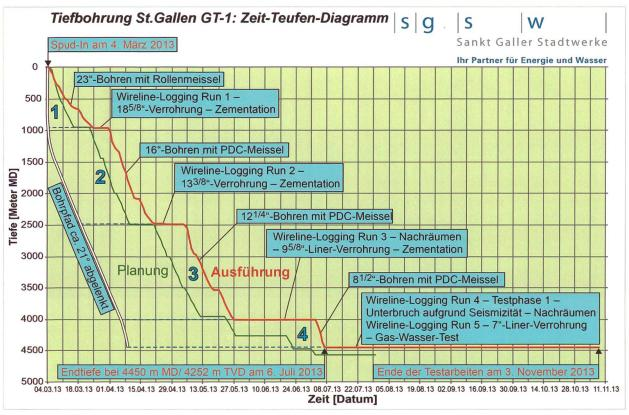
Abbildung 5: Zeit/Teufen-Diagramm der Bohrung St. Gallen GT-1, mit Darstellung der wichtigsten Arbeitsphasen in den Bohrloch-Sektionen 1 bis 4 (grün = Planung, rot = Realisierung).
