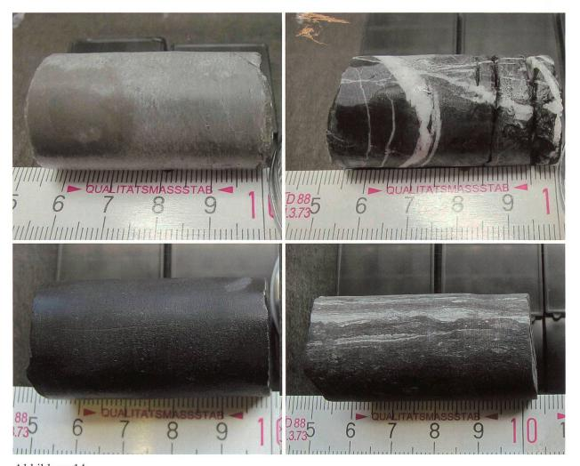
Abbildung 14: Beispiele von intakten Seitenkernen (MSCT) aus der Malm-Dogger-Strecke. Oben links: heller, mikritischer Kalkstein bei 4100 m MD. Oben rechts: stark geklüfteter dunkler Kalkstein aus dem Bereich der Wohlgeschichteten Kalke. Unten links: Dunkler feinsandiger Kalkmergel aus den untersten Impressamergeln. Unten rechts: Laminierter Feinsandstein aus dem «Oberen Dogger».
