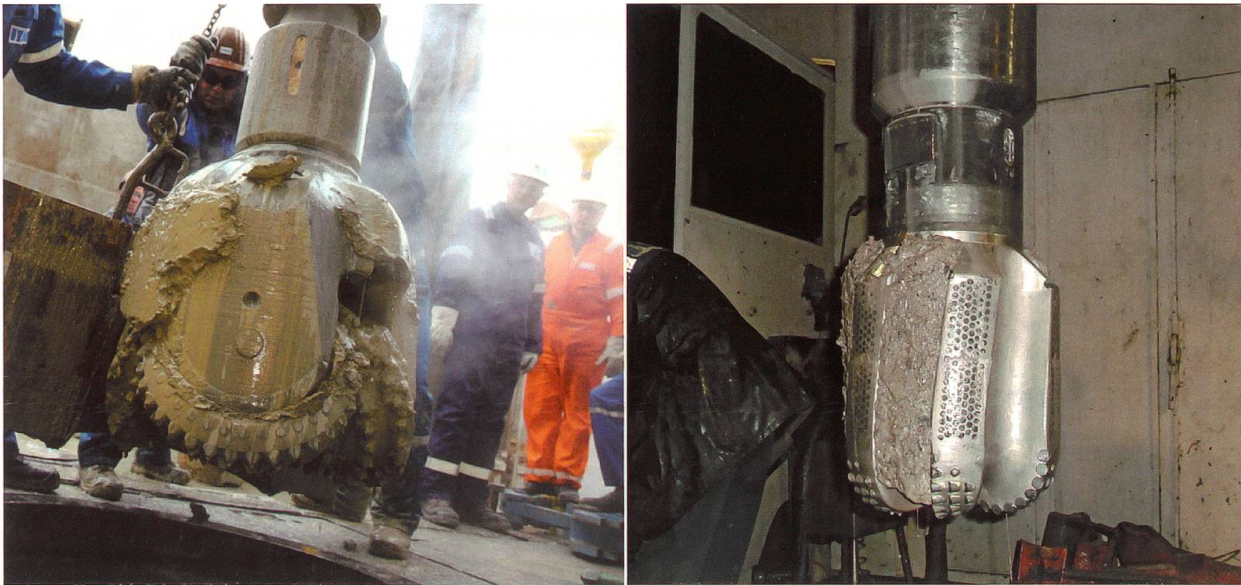
Abbildung 6: Links: Konventioneller 23"-Rollenmeißel, wie er in der Sektion 1 zum Einsatz kam, stark mit tonreichem Bohrgut verklebt. Rechts: Moderner 18"-PDC-Meißel teilweise noch mit Bohrgut aus der jüngeren USM (Oberaquitane Mergelzone in Sektion 2).
