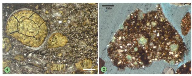
Abbildung 11: St. Gallen GT-1: Mikrofazies im Dogger mit: Links: Geschrumpftes und kompaktiertes Eisenooid mit internen Brüchen und Kalzit-Zementen an Ober- und Unterseits (Seitenkern, 4414 m MD). Rechts: Feinsandiger Kalkmergel mit Glaukonitkörnern (Cutting, 4415 m MD).
