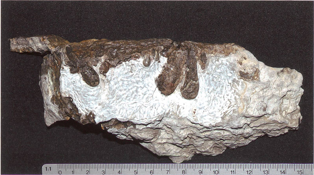
Abbildung 7: Grosse Bohrmuschellöcher (über 30 mm lang) im Schrattenkalk; Hartgrund unter Stromatolith, Girenspitz oberhalb Blauschnee, SBHG-BIV4.
