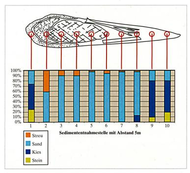
Abbildung 4: Art und Verteilung ausgewählter Bodenbestandteile einer Pionierinsel.
