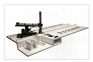
Abbildung 1: Der schwenkbare Arm des UNO-Roboters kann die Karten rechts der Fahrbahn nach links legen und umgekehrt.
