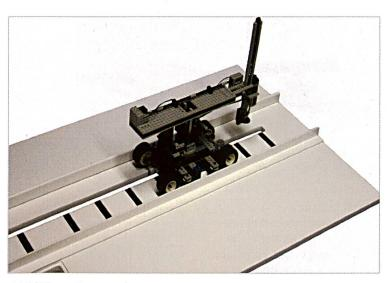
Abbildung 2: Mit den Strichen auf der Fahrbahn stellt der Fahrroboter fest, wo er sich gerade befindet.
