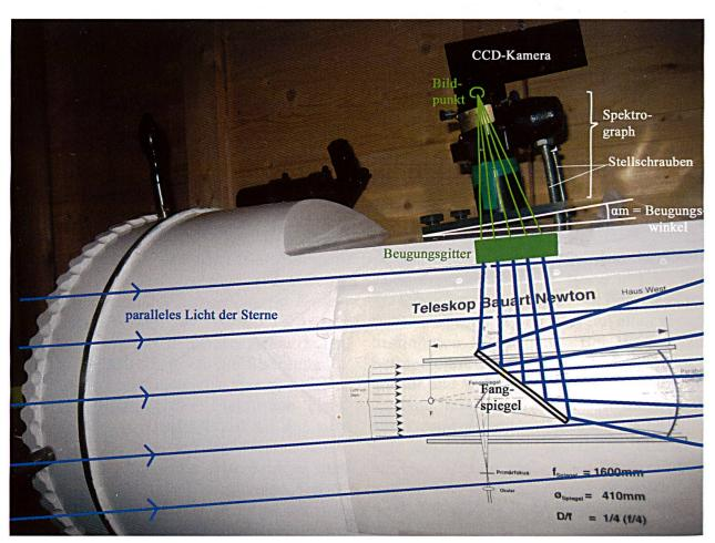
Abbildung 2: Der Spektrograph besteht aus dem Beugungsgitter und der CCD-Kamera. Der Winkel  $\alpha_m$  kann durch Drehen an den Stellschrauben eingestellt werden.
