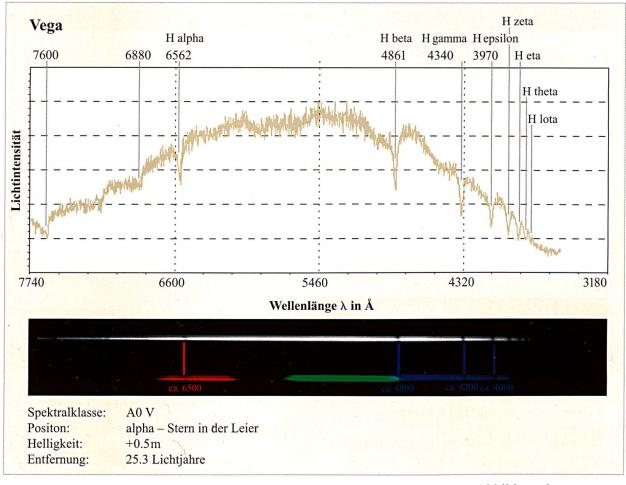
Abbildung 6: Spektrallinien und deren Messung vom Stern Vega.
