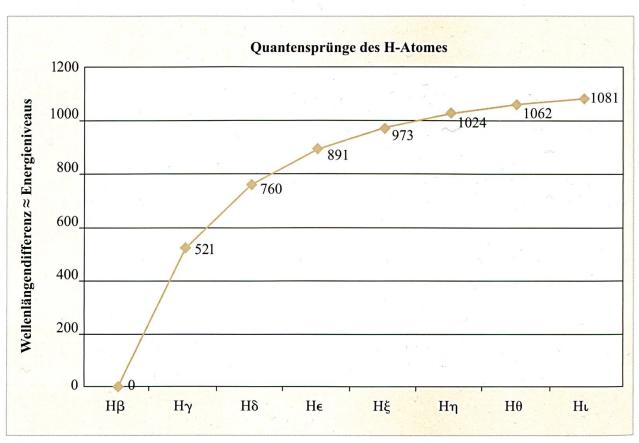
Abbildung 5: Mit zunehmender Distanz zum Atomkern, benötigt das Elektron pro Schalenwechsel immer weniger Energie. Dies ist mit der Abflachung der Kurve zu erkennen.
