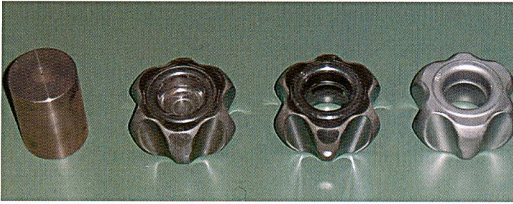
Abbildung 20: Links der Rohling, rechts unterschiedlich ausgepresste Kugelnaben. Foto: Christoph Battaglia, NTB.
