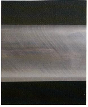
Abbildung 2: Periodische Ablagerungen von Ammoniumchlorid (NH<sub>4</sub>Cl) in einem Glasrohr von 5 cm Durchmesser.
