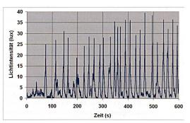
Abbildung 10: Rhythmisches Aufleuchten des Platindrahts in warmem Methanoldampf, gemessen mit einer Lichtsonde. Es ist deutlich ersichtlich, dass die Oszillationen in den Perioden variieren.
