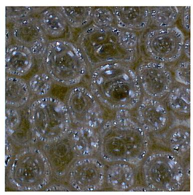
Abbildung 16: Schnitt durch den Schaumstoff Polyurethan in 50-facher Vergrösserung – eine periodische, chemische Reaktion bildet dreidimensionale Strukturen.
