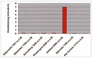
Abbildung 4: Dosisleistungsmessungen<sup>5</sup> 1 m über dem Boden (Mittelwerte aus 6 Messungen pro Punkt). Die stark erhöhte Radioaktivität am «Hotspot» ist im Wesentlichen durch das Uranerz bestimmt.
