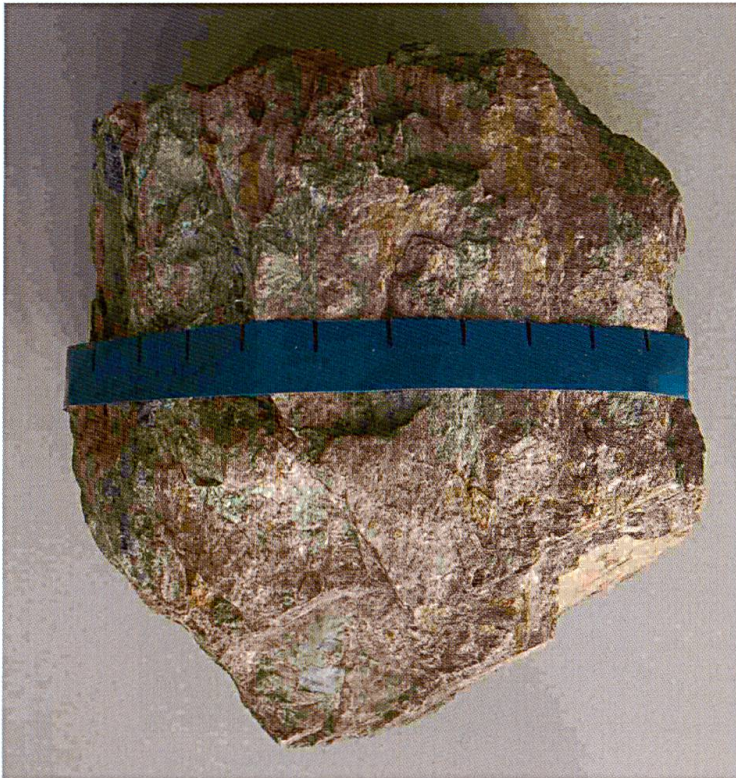
Abbildung 6: Ein Handstück vom 'Hotspot' mit dem blauen Band der Messpunkte und Messlinie (Messungen: Abbildung 7).
