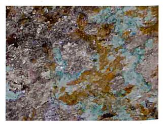
Abbildung 8: Mikroskopische Aufnahme (50x) von einem Bereich mit viel Kupfererz.
