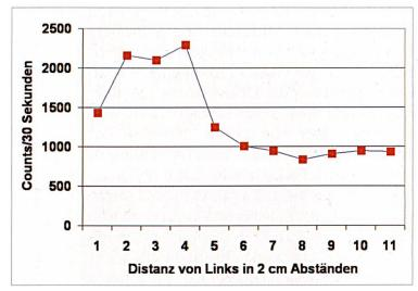
Abbildung 7: Inhomogene Aktivitätsverteilung bei dem Stein (ca. 20 x 20 cm, Abbildung 6) vom «Hotspot». Zählrohr<sup>6</sup> bei jeder Marke auf der Mitte des blauen Messstreifens und der Messmarke (siehe Bild). Auffällig ist die gute Übereinstimmung von türkisfarbenem Kupfererz und der Radioaktivität.
