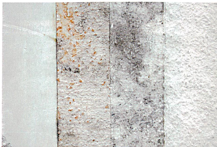
Abbildung 2: Pilz-Wachstumsversuch in der Feuchtkammer: Auf Gips (Streifen links) sind die angeimpften Pilze nicht gewachsen; auf dem 2. Streifen von links wachsen sie auf der Rauhfasertapete, auf dem 3. Streifen wächst eine ganz anders aussehende Pilzpopulation auf einer Innendispersionsfarbe (Anstrich auf der Tapete). Auf dem 4. Streifen rechts verhindert ein pilzwidriger Zusatz in der «Schimmelfest-Dispersion» das Pilzwachstum.
