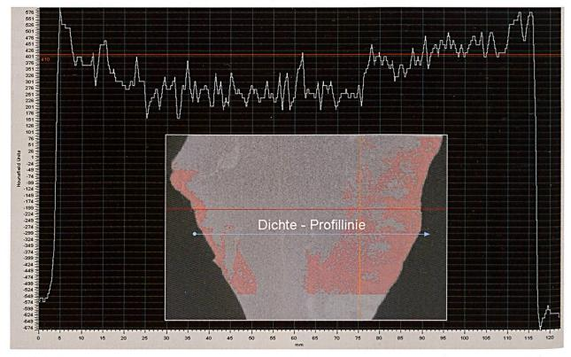
Abbildung 4: Dichteprofil der Versteinerung gemessen in Hounsfield Units.
