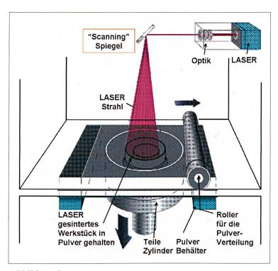
Abbildung 9: Funktionsschema des Selective Laser Sintering Prozesses (SLS).
