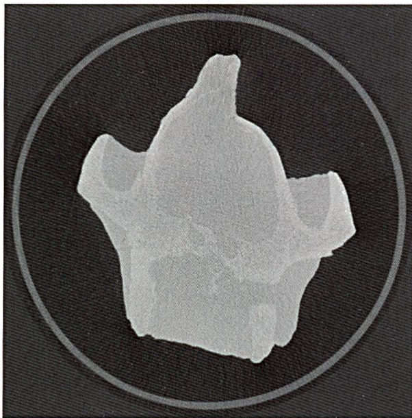
Abbildung 8: Eines von 919 Schnittbildern aus dem Tomographen. Deutlich erkennbar ist der hellere Knochen. Aufnahme: Empa Dübendorf.
