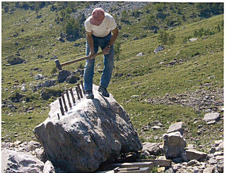
Abbildung 8: Crioceratites LEVEILLÉ 1837. Anschliessend wer- den Keile in die Löcher getrieben. Das Abspren- gen erfolgt rein mecha- nisch. Foto: Peter Raschle.
