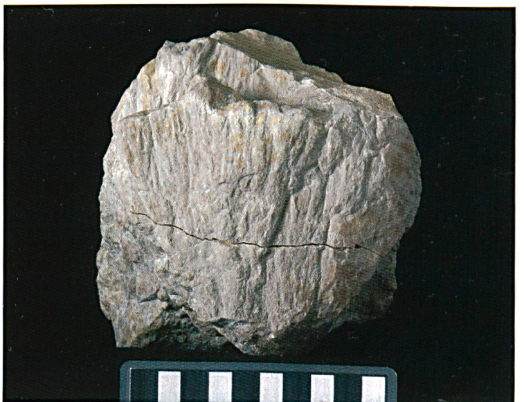
Abbildung 3: Relativ grob ausgebildeter Shatter Cone (C). Eine zweite Fläche ist oben er- kennbar. Fund 2003 (NMBE 37037). Maximale Breite der Probe 13 cm. Foto Peter Vollenweider.
