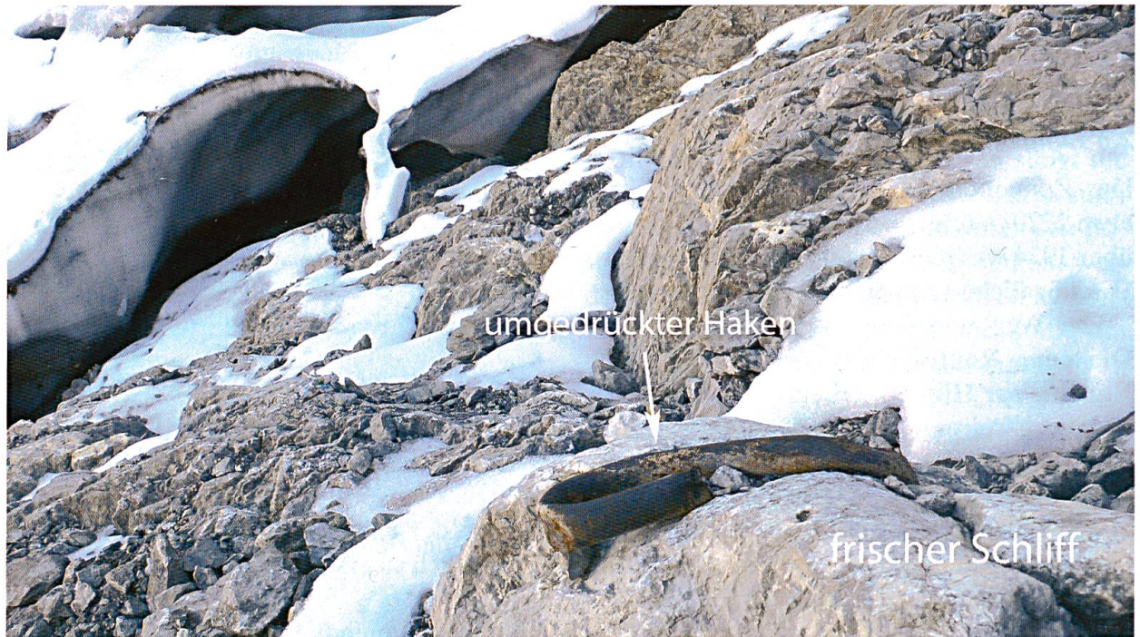
Abbildung 14: dieser Sicherungshaken ist von der Eislast flachgedrückt worden. Foto Hans Aeschlimann.
